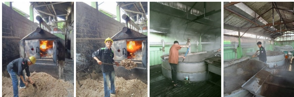
Gambar 3. Pembakaran Ampas Tebu dan Pemasakan Nira
