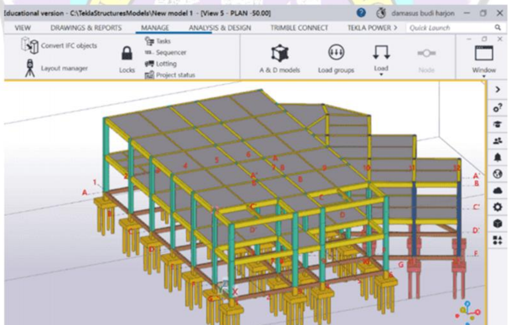
Balok & Plat Lantai 3
