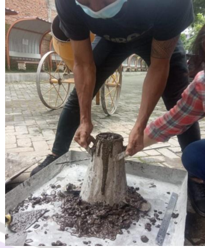
Proses Pengecoran dan Pengujian Slump Test
