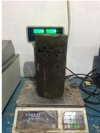
Proses Persiapan Pengujian Kuat Tekan, Kuat Tarik Belah, dan Modulus Elastisitas Beton Geopolymer
