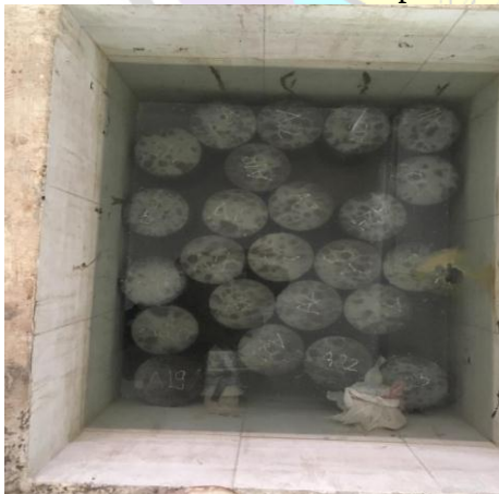
Perendaman Beton Selama 7, 14, 21, dan 28 Hari dan dikeluarkan untuk dianginkan
