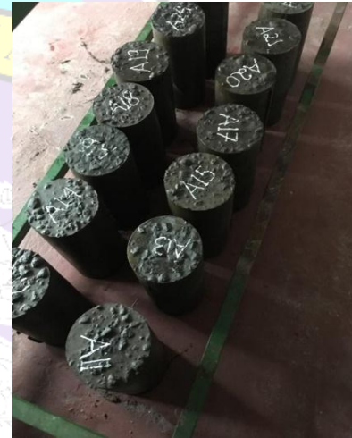
Beton Dalam Cetakan didiamkan Selama 24 Jam dan setelah 24 Jam Beton di lepaskan dari Cetakannya
