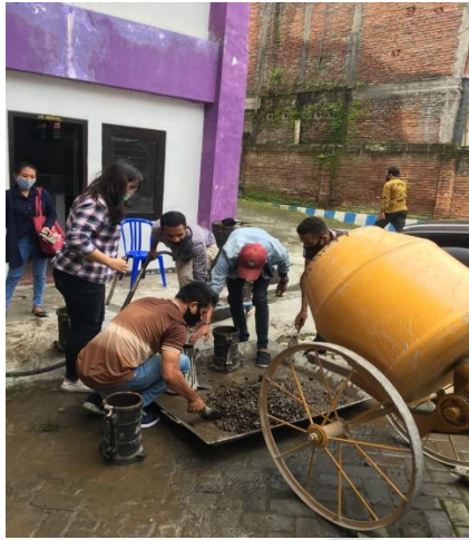
Proses Pengecoran dan Pengujian Slump Test
