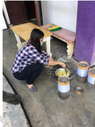
Proses Persiapan Pengujian Kuat Tekan, Kuat Tarik Belah, dan Modulus Elastisitas Beton Geopolymer
