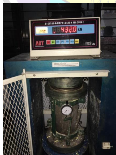
Hasil Pengujian Kuat Tekan, Kuat tarik Belah dan Modulus Elastisitas Beton Geopolymer Variasi Umur Beton 28 Hari
