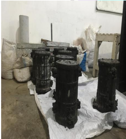
Beton Dalam Cetakan didiamkan Selama 24 Jam dan setelah 24 Jam Beton di lepaskan dari Cetakannya
