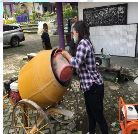
Persiapan Benda Uji Silinder dan Proses Pengecoran
