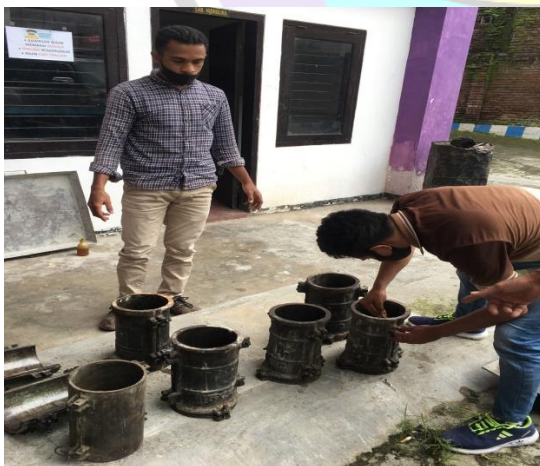
Persiapan Benda Uji Silinder dan Proses Pengecoran
