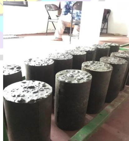
Perendaman Beton Selama 7, 14, 21, dan 28 Hari dan dikeluarkan untuk dianginkan
