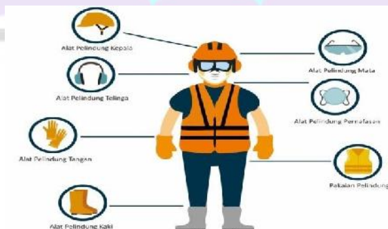
Gambar 2 1 alat Pelindung Diri Konstruksi Sumber : Google. Com
