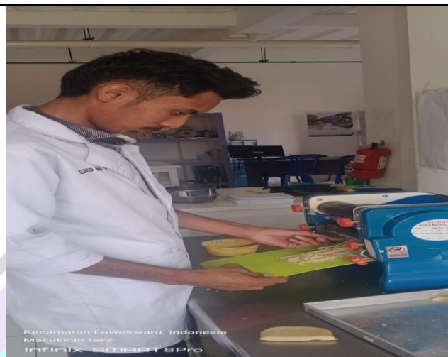
Proses pencetakan untuk pembuatan untaiyan mie
